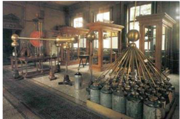
Fig. 6. Von Marus' generator connected with a big Leyd jar (it generates 300 kV high voltage) Generatorul, conectat cu un sistem de butelii de Leyda, generează o tensiune de 300 kV
